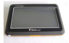
Le GPS 900S possède un écran tactile de 4.3' (10.9 cm de diagonale), avec une résolution de 480 x 272 pixels.
