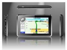
Ce GPS possède un écran tactile de  $4.3^{\circ}$  (10.9 cm de diagonale), avec une résolution de  $480 \times 272$  pixels.
