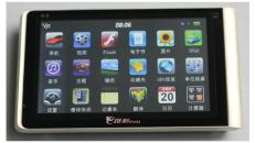
Le GPS 960N possède un écran tactile de 5' (12.7 cm de diagonale), avec une résolution de **800 x 480 pixels**.
